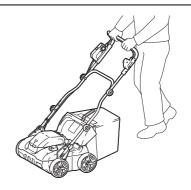
・ 本製品のデッキ上のマークの幅が作業幅の目安です。
