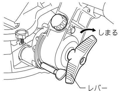
例：左傾斜角度を  $30^{\circ}$  に設定する場合
