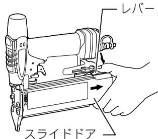
2. 釘の先端をマガジン底部の溝に確実にはめ込むようにして装てんしてから、釘全体を指で射出口へ送り込みます。
