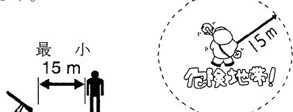
2. 刈払機を使用している人に近づくときは、使用者から15m以上離れた位置で合図し、エンジンの停止と刈刃の回転の停止を確認してから近づいてください。
