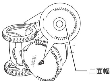
4. 六角ナットを付属のメガネレンチで時計方向に回して、確実に締めてください。締め付ける際、六角ナットは図の向きで締め付けてください。
