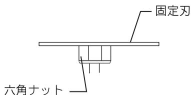
5. アンダープレートを時計方向に回して締め付けてください。
