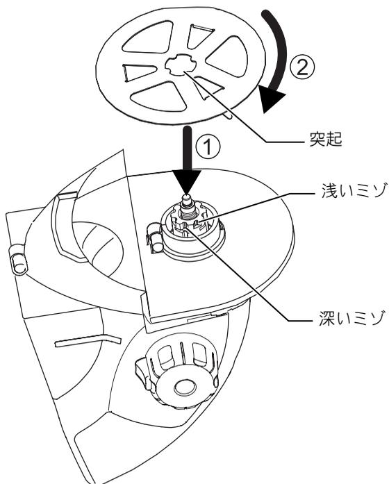
2. ロータリーブレードの文字の書いてある面を外向きにし、駆動軸の形状に合わせてはめ込みます。
