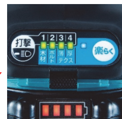
後方に配置された操作パネル
