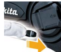
↑ツマミを回してチェーン刃のテンションを調整
