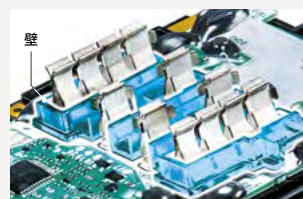
端子短絡防止構造
