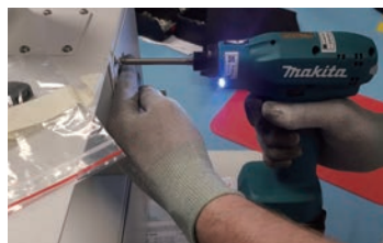
▲人工呼吸器の製造ラインで採用されたトルク管理用の充電式スクリウドライバ
