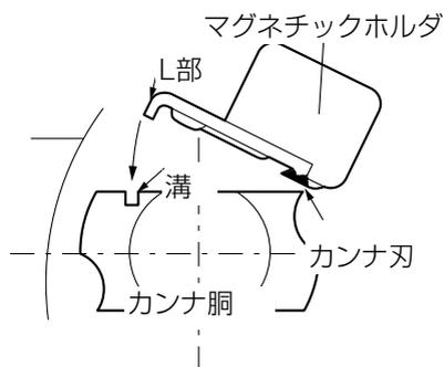
4 カナナ胴の溝にセットプレートのL部を入れ、セットプレートのボルト穴とカナナ胴のネジ穴を合わせて六角ボルトを取り付けてください。
