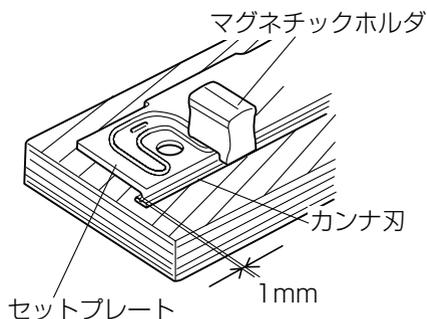
2 カナナ刃がセットプレートの両端から1mmほど出るようにセットプレートの位置を調整してください。
