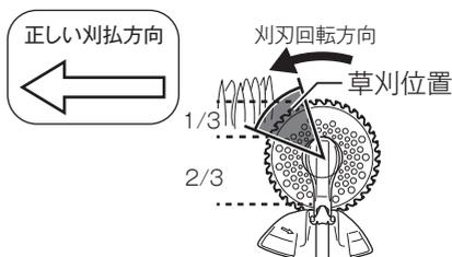
刈刃の先端から右側部分で草を刈ったり、硬いものに接触すると、刈刃の回転で障害物を駆け上がる力が働き、本機が右側に大きくはねるキックバック現象が発生することがあり、けがや事故の原因になります。
