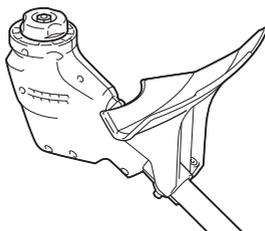
3. モーターハウジングの穴に六角棒レンチを差し込み、刃受金具が回らないように固定します。
