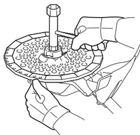
9. 始動前に、刈刃にひび割れ、傷（欠け、摩耗など）、変形などの異常がないことを確認し、異常のあるものは使用しないでください。なお、刈刃点検時には手袋を着用してください。
