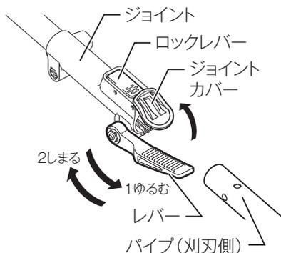
3. ジョイントの凹部にパイプ（刈刃側）の凸部の位置を合わせ、パイプ（刈刃側）をジョイントの奥まで差し込み、ロックレバーの上面が水平になっていることを確認します。
