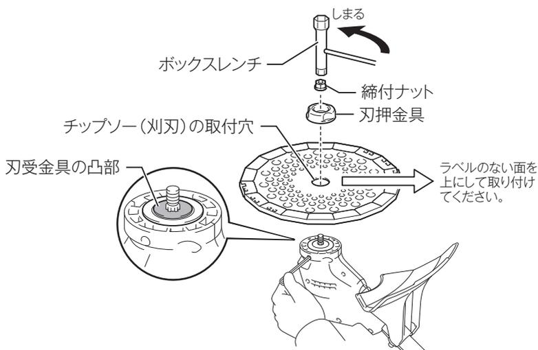
7. 六角棒レンチをはずし、チップソー（刈刃）を手で軽く回してチップソー（刈刃）の取付穴が刃受金具の凸部からずれていないことを確認します。ずれている場合は、もう一度チップソー（刈刃）を取り付け直してください。
