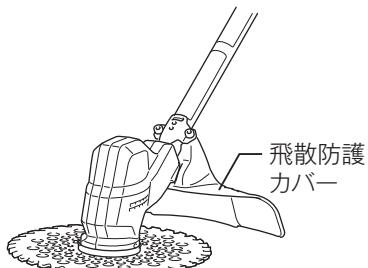
12. ナイロンコードカッタを使用できる製品は、ナイロンコードカッタ専用の飛散防護カバーを使用してください。飛散防護カバーを取り付けるときは、ナイロンコード用のカッタに触れないでください。
