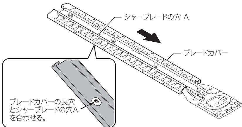
4. シャープブレードがずれないように A の穴にプラスネジを貫通させて仮固定します。(B 部の上刃と下刃の穴がそろいます。) プラスネジはすでにはずしたプラスネジ 4 本のうちの 1 本を使用します。
