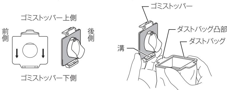
2. ゴミストッパーとダストバッグの枠を重ね合わせ、本製品に取り付けます。
