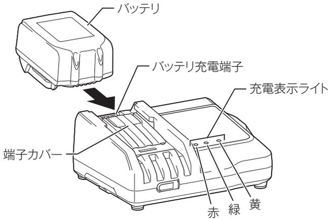
1. 充電器の電源プラグを 100 V の電源コンセントに差し込みます。
