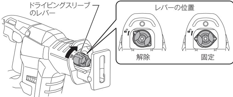
2. ブレードをドライビングスリーブの奥まで差し込みます。スリーブが回転して、レバーが固定位置で止まります。
