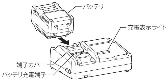
1. 充電器の電源プラグを 100 V の電源コンセントに差し込みます。
