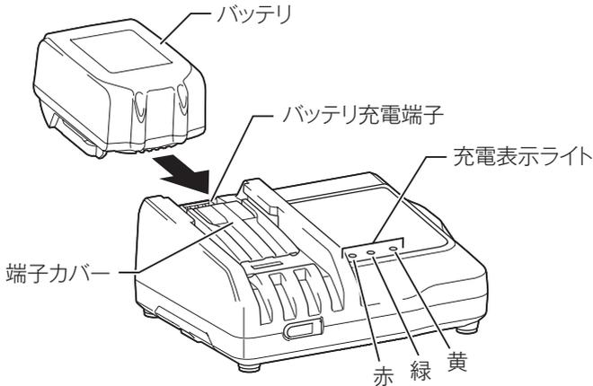
1. 充電器の電源プラグを 100 V の電源コンセントに差し込みます。
