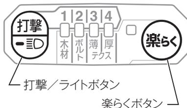
2. 1・2・3・4ランプが点滅したら指を放します（解除完了）。
