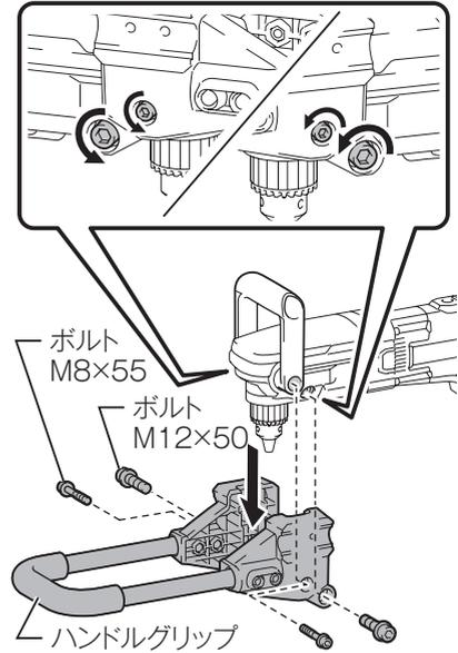
6. 保管しておいたフロントハンドルの固定用ボルト (M8 × 30 (2 本)) で、フロントハンドルを取り付けます。
