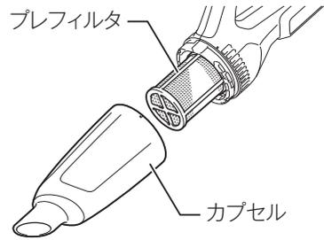
4. プレフィルタを回して、本製品から固定用突起をはずしてから引き抜きます。
