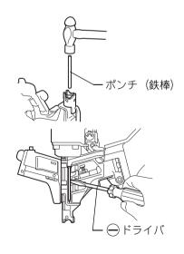
・ 除去作業が完了したら、再度、釘を装てんしてください。
