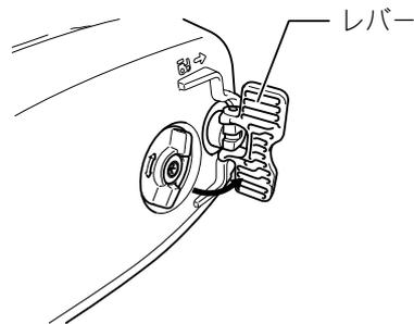
3. レバーを押し込みながら左（反時計回り）へ約 1/4 回転回してナットを軽くゆるめます。（レバーを押し込むとガイドバーを固定しているナットとレバーがかみ合います。）
