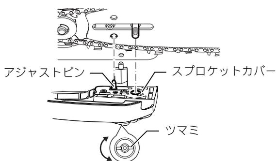
8. レバーを押し込みながらレバーが止まるまで右へ回してから、左へ約 1/4 回転回して軽くゆるめます。
