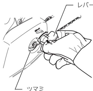
9. チェーン刃の調整 (P10 参照) に従って、チェーン刃の張りを調整し、レバーを押し込みながら右へ回してしっかり締めます。
