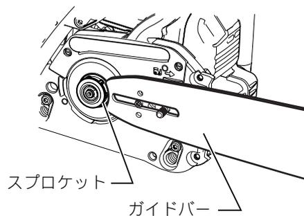
5. 刃の向きに注意して、チェーン刃をスプロケットに掛け、スプロケット側から順にガイドバーの溝にチェーン刃を入れてください。
