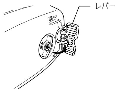
3. レバーを押し込みながら左（反時計回り）へ回してスプロケットカバーがはずれるまで回します。
