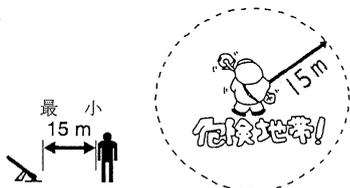
2. 刈払機を使用している人に近づくときは、使用者から15m以上離れた位置で合図し、エンジンの停止と刈刃の回転の停止を確認してから近づいてください。
