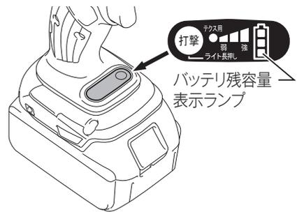
バッテリー残容量表示ランプの点灯状態とバッテリー残容量は以下のようになっています。
