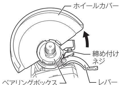
3. ホイールカバーを矢印の方向に 180° 回してレバーを閉じ、締め付けネジを締めて固定します。
