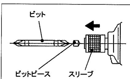
・市販品(ビットピースを使用)の場合は、スリープを矢印方向に引きビットピース・ビットの順に差し込み、スリープを離してください。
