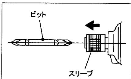
・マキタ純正品の場合は、スリープを矢印方向に引きビットを差し込み、スリープを離してください。
