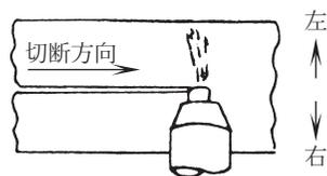
トーチが切断方向に対して、右に傾いていますと、左側にスパッタが飛び、逆に左に傾いていますと右側にスパッタが飛びます。左右にスパッタが飛ばない状態の時、トーチはほぼ垂直になっています。
