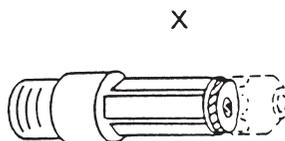
電極の長さが溝より短くなりますと、トーチを焼損する恐れがありますので溝部以上では絶対に使用しないでください。
