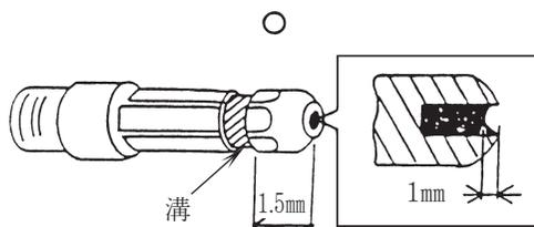
電極の先端から 1.5 mm の所に溝があります。電極の消耗がこの溝に達するまでに交換してください。切れ味からみて、中央部が 1 mm 以上掘れたら交換するようにしてください。
