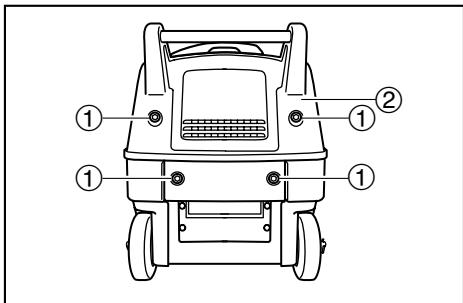
2. ボルト①をゆるめて、バッテリボックス②を外します。
