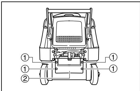
3. バンド①を取り外して、バッテリ②を外します。
