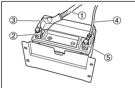
7. バッテリボックスにバッテリを取り付け、バンドで固定します。
