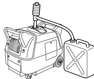
4. ストレーナおよび燃料タンクキャップを取り付けます。
