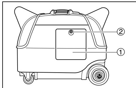
12.本体サイドカバー①を取り付け、ボルト②を締め付けます。
