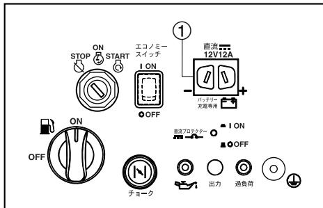
5. 充電コードの赤色端子①をバッテリの+端子に接続します。
