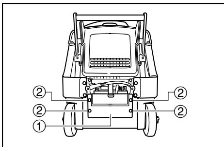
9. カバー①を取り付けて、ボルト②を締め付けます。
