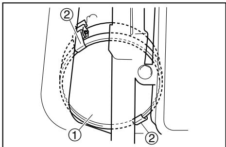
13.サイドカバー①を取り付け、スクリュ②を締め付けます。
