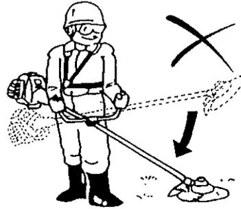
9. 跳ね返り（キックバック）を防止するため、8時から11時の位置で切断してください。
