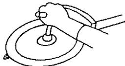
3. 刈刃を取り付ける場合は、刃受金具の凸部と刈刃の取り付け穴を確実にはめてください。
