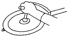
3. 刈刃を取り付ける場合は、刃受金具の凸部と刈刃の取り付け穴を確実にはめてください。
