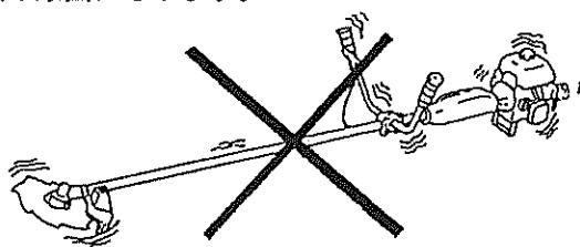
9. 刈払機から離れる時または、休憩時にはエンジンを停止し刈刃の回転が停止したことを確認してから刈刃に刃物カバーを取り付けてください。
