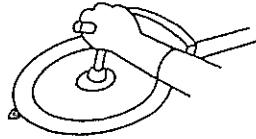
3. 刃刃を取り付ける場合は、刃受金具の凸部と刃刃の取り付け穴を確実にはめてください。
