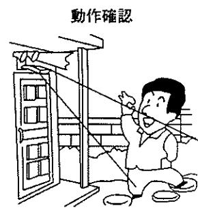
○エリア調整の必要があれば、再び、ロックナット、エルボーアーム、蝶ネジの操作によって適切なエリアに設定し直して下さい。
