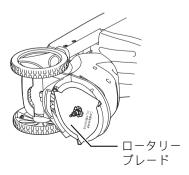
3. 固定刃の文字の書いてある面を外向きにし、駆動軸の形状(二面幅)に合わせてはめ込みます。
