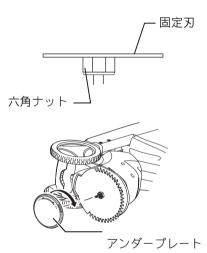
6. 最後にプレートの突起を矢印方向に回して、プレートの仮固定を解除してください。
