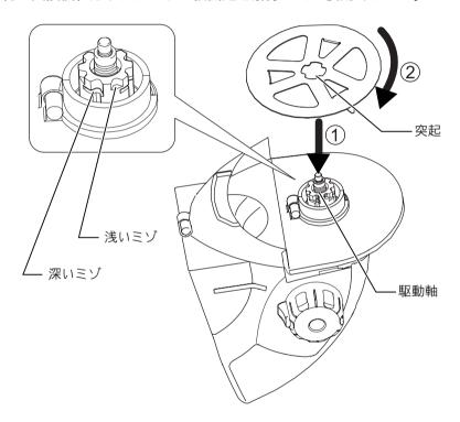
2. ロータリーブレードの文字の書いて ある面を外向きにし、駆動軸の形状に 合わせてはめ込みます。
