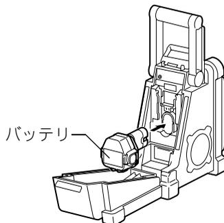
4. バッテリー収納カバーを閉じ、ロックをします。
