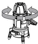
リモコン追尾受光器の赤外線通信窓を墨出し器に向けて回転スイッチを押すと墨出し器が回転します。スイッチは左/右回転どちらか回転させたい方向を選んでください。
