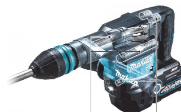
アクティブ動吸振器 防振二重構造 「おもり」を「ピストン」と逆方向に押し出し、前後の振動を相殺。 「防振パネル」で振動を吸収。
