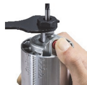
シャフトロック付き ボタンを押しながらスバナ1本で簡単にビット交換
